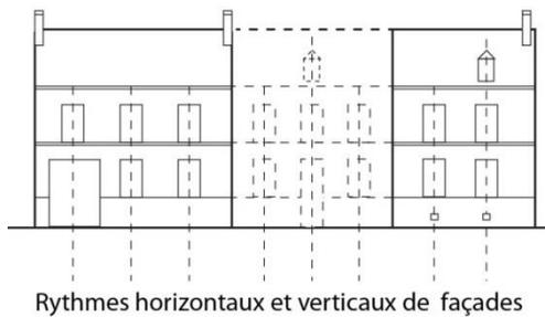
Si des lucarnes existent déjà en toiture, il pourra en être créé de nouvelles ; dans ce cas, elles reprendront les dimensions des lucarnes existantes. Elles seront placées au droit d'une travée de baie. Les ouvrages techniques liés à la ventilation, climatisation et chauffage seront interdits en toiture.
