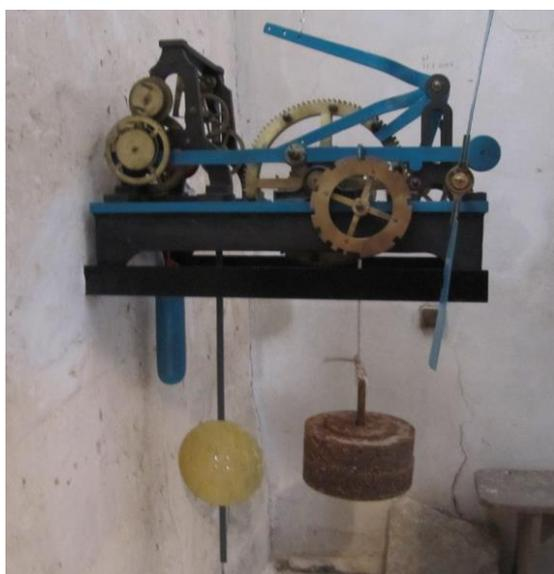
L'horloge après restauration et réinstallation dans le clocher
